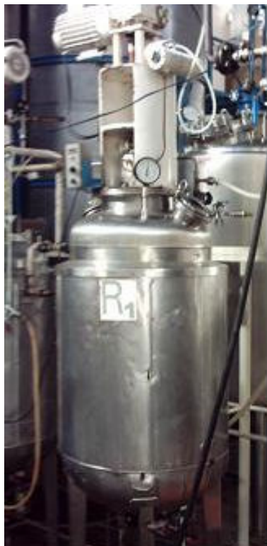
Fig. 1. Foto del Reactor de 250 litros de capacidad real.
