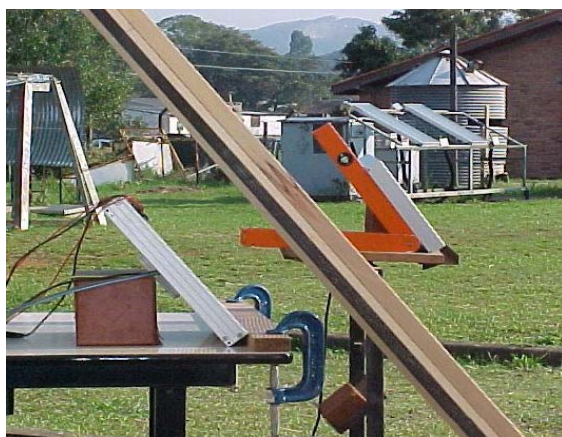
Figura 5. Célula de referência e célula sob teste, com a tela de sombreamento paralela a seu plano.
